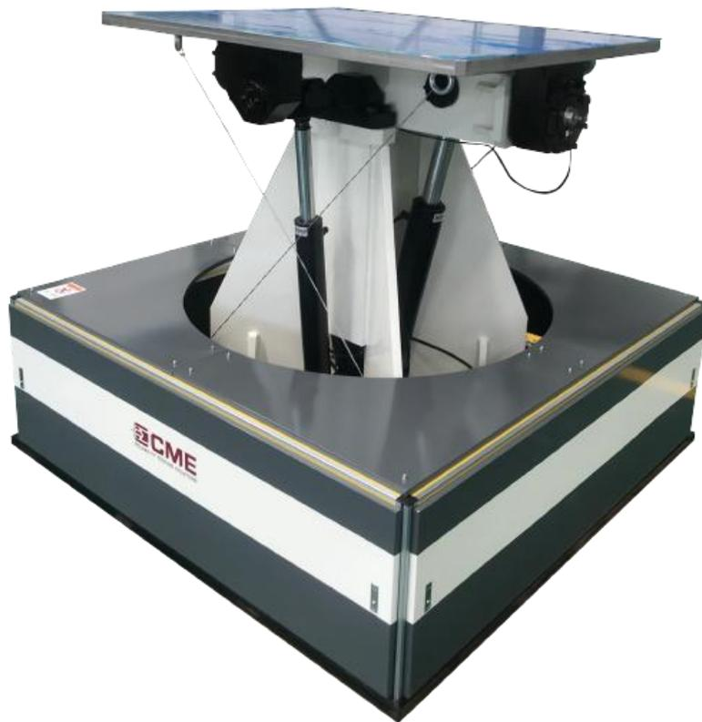
KRD60 倾斜摇摆试验台模拟安装在船舶、水上飞机和其他设备上的各种机械、电气和电子产品，进行摇摆和倾斜试验，以确定产品承受严重摇摆和倾斜要求的能力和结构完整性。倾斜试验主要适用于船舶损坏、操纵、装卸不平衡、风等引起的大角度倾斜。摇摆试验主要适用于船舶在风、浪等外力作用下长期摇摆，必须正常维护或工作可靠的产品，以及在摇摆环境中对其性能有重大影响的产品。
