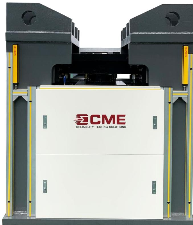
KRD14 系列气动垂直冲击响应谱试验机用于测量和测定电工电子产品或包装的抗冲击性能，评价被测产品在冲击环境中的可靠性和结构完整性。冲击响应谱是一系列具有不同固有频率的单自由度线性系统在同一冲击激励下响应的总和。当产品受到冲击时，其冲击响应的最大值意味着产品具有最大应力。因此，冲击响应谱测试仪能够更好地模拟真实环境中所遭受的冲击波和冲击能量。
