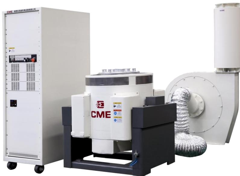
KRD01 系列电磁振动台是一种风冷式电振动测试系统, 具有频率宽、性能优良、可靠性高、占地面积小、移动方便、操作简单等优点。具有正弦、随机、经典冲击和复合振动试验能力, 符合相关试验标准。
