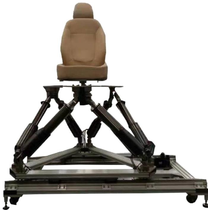
KRD61 六自由度摇摆试验台是一个由六个伺服执行机构和六组分别连接在平台顶部和底部的专用铰链组成的闭环伺服仿真平台。通过六个执行器的伸缩运动，上平台以六个自由度 (X、Y、Z、 $\alpha$ 、 $\beta$ 、 $\gamma$ ) 运动，可以模拟各种空间运动姿态。
