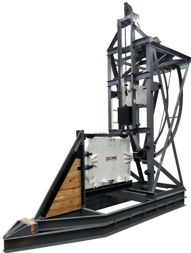
KRD16 强冲击试验台符合 MIL-S-901D 标准, 该标准涵盖了船用机械、设备、系统和结构的冲击试验要求, 不包括潜艇耐压壳贯穿件。这些要求的目的是验证船上装置承受战时核武器或常规武器作用可能产生的冲击载荷的能力。
