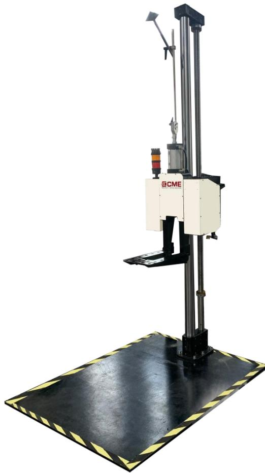
KRD41 系列摆臂式跌落测试仪适用于小型消费电子产品和组件的自由落体测试，例如手机，对讲机，电子词典，CD / MD / MP3 等，适用标准 JISC 0044 和 IEC 60068-2-32。通过对电子产品进行标准测试（表面下降，拐角下降，边缘下降等）并收集数据，它可以模拟电子产品在运输和处理过程中垂直下降的影响。它为产品的缓冲和减振设计以及结构材料的选择提供了基础。
